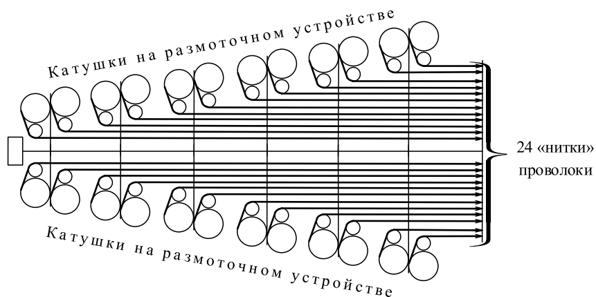
Рисунок 2. Схема размоточного устройства технологической линии
