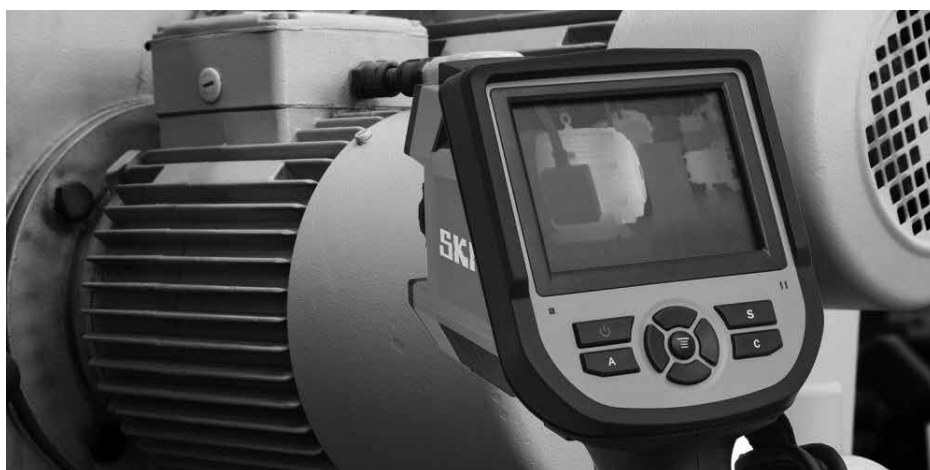
Рисунок 1. Измерение нагрева поверхности тепловизором
