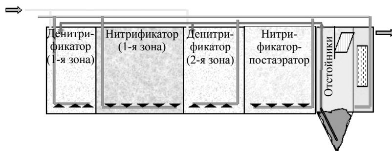
Рисунок 1. Технологическая схема очистки сточных вод в аэротенке с одноиловой системой денитри-нитрификации
