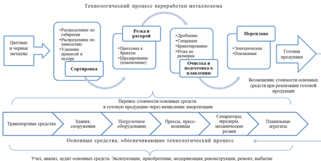
Рисунок 1 - Модель обеспечения основными средствами технологического процесса переработки металлолома
