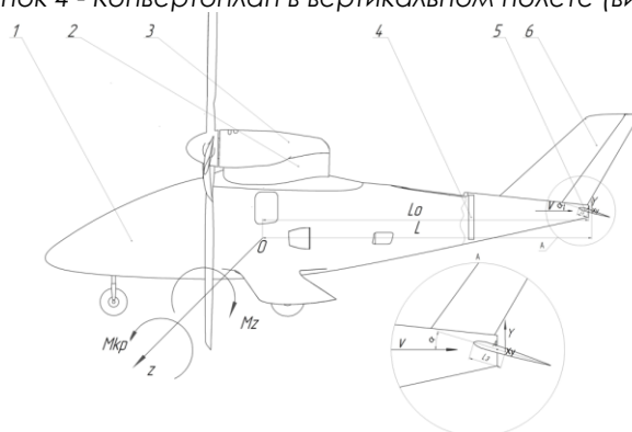
Рисунок 5 - Силы и моменты, действующие на конвертоплан в полете
