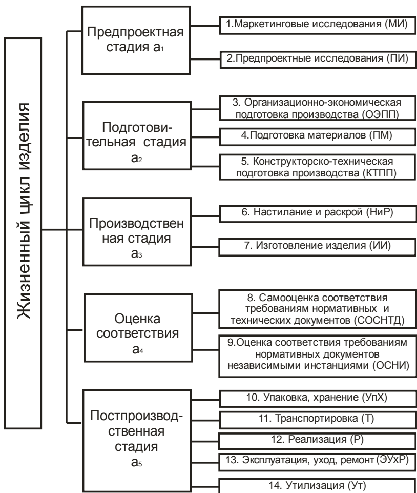
Рис. 4.4. Обобщенная структурная модель ЖЦ одежды
