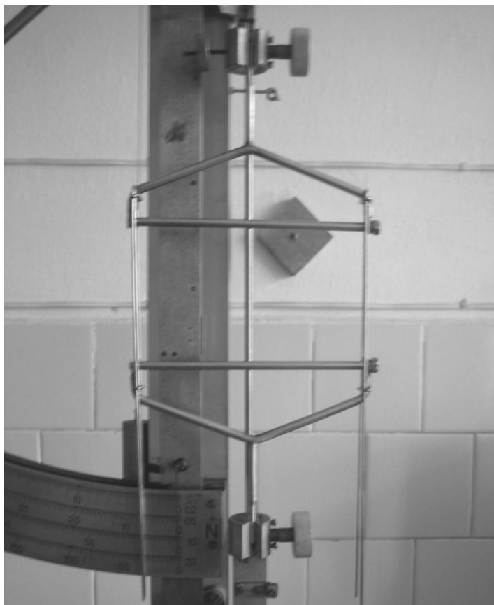
Рисунок 1 – Внешний вид спецприспособления для исследования деформационных свойств ВЭМ
