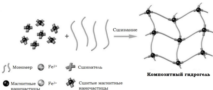
Рис. 2. Схема синтеза композитного гидрогеля методом сшивания
