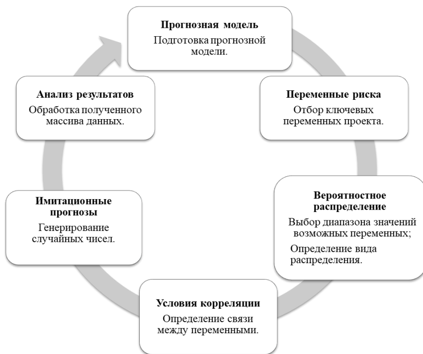
Рисунок 2 – Алгоритм работы по методу Монте-Карло Monte Carlo algorithm
