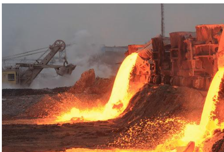
Рис. 2. Слив раскаленного жидкого доменного шлака
