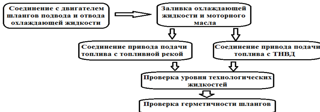
Рисунок 2 - Технологический процесс подготовки двигателя к диагностике (2 этап)
