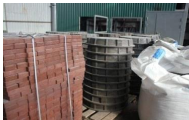
Рисунок 4 – Тротуарная плитка и колодезные люки из полимерпесчаной смеси, производившиеся в г. Оренбурге
