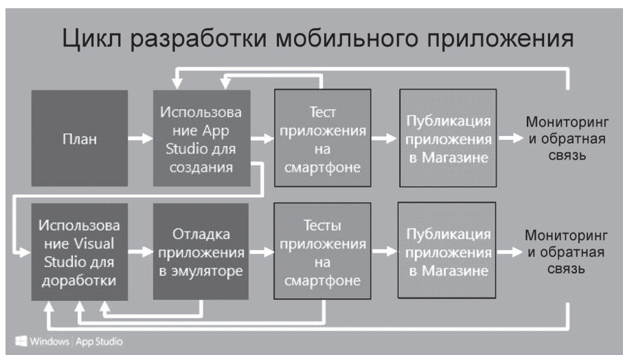
Рис. 6. Цикл разработки мобильного приложения для Windows Phone (сост. авт.)
