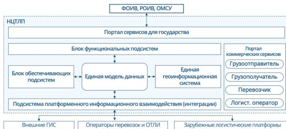
Рис. 4.6. Функциональная архитектура НЦТЛП
