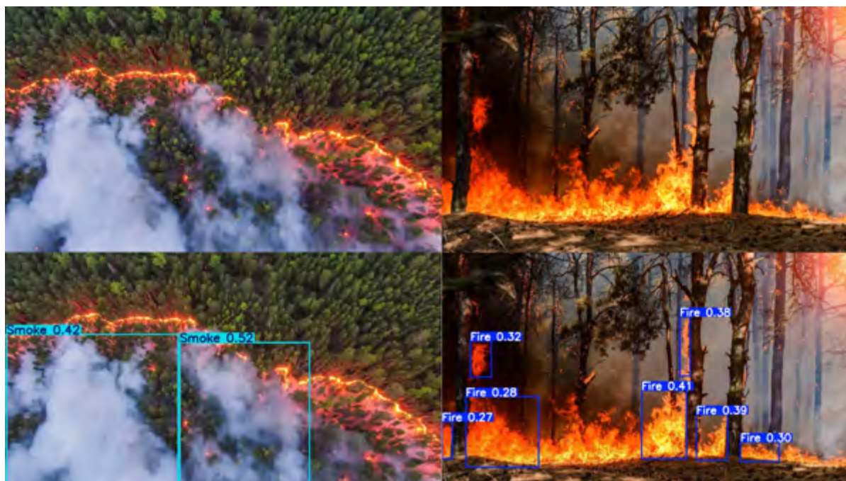
Рисунок 2 – Результат обнаружения пламени и задымления с использованием модели YOLO11n
