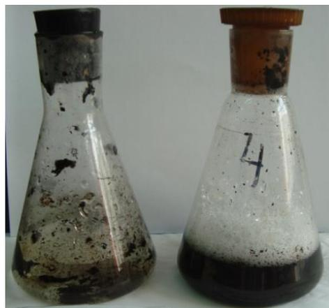
***Рисунок 7. Диспергирующие свойства «Нефтенол МЛ» при 60°C, скв. 227 Уршакского месторождения***
