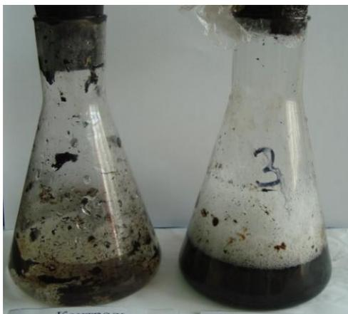
***Рисунок 6. Диспергирующие свойства «Девон-5в» марки А при 60°C, скв. 227 Уршакского месторождения***
