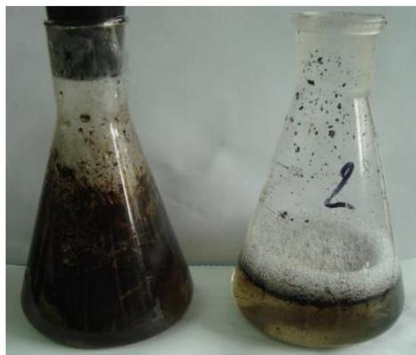
***Рисунок 10. Диспергирующие свойства «Оксикор 15ПАВ» при 70°C, скв. 331 Толбазинского месторождения***
