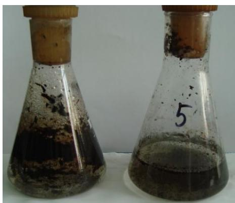
***Рисунок 11. Диспергирующие свойства «РХП-30» при 70°C, скв. 162 Янгурчинского месторождения***
