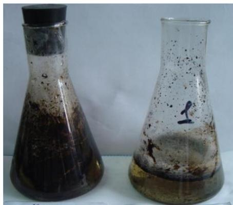
***Рисунок 9. Диспергирующие свойства «Акватек 512 SAR» при 70°C, скв. 331 Толбазинского месторождения***
