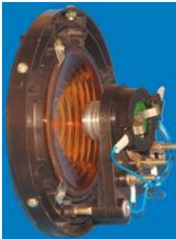
***Рисунок 3. Установка светодиодной лампы в линзовом комплекте железнодорожного светофора***
