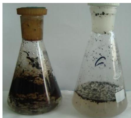
***Рисунок 12. Диспергирующие свойства «Сульфанол» при 70°C, скв. 162 Янгурчинского месторождения***
