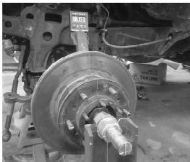
Рис. 12. Стапель для поворотного кулака
