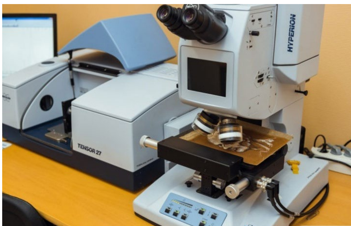
Рис. 4. Пример использования метода инфракрасной спектроскопии для изучения произведения искусства
