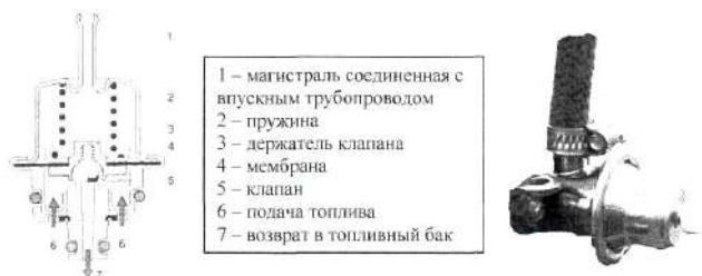
Рис. 6.10. Регулятор давления
