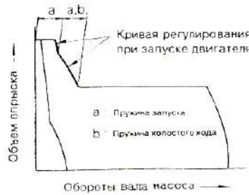
Рис. 10.5. График зависимости объема впрыска от оборотов насоса с указанием действующих пружин
