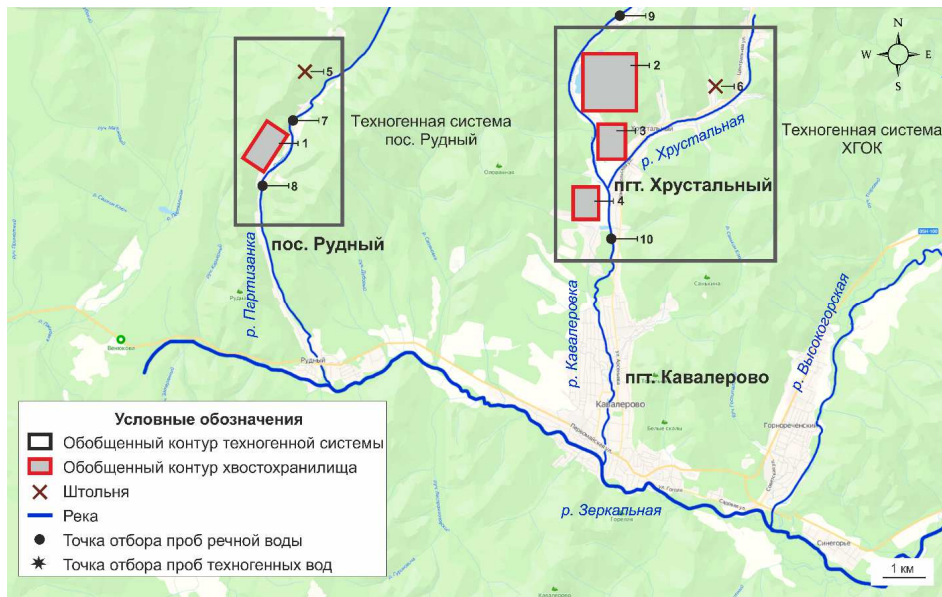
Рис. 18.2. Схематическая карта горнопромышленных техногенных систем Кавалеровского района: 1 – ХВ в пос. Рудный; 2–4 – комплекс ХВ ХГОК; 5 – шт. Капитальная; 6 – м. Хрустальное; 7 – р. Партизанка выше ХВ; 8 – р. Партизанка ниже ХВ; 9 – р. Кавалеровка выше комплекса ХВ ХГОК; 10 – р. Кавалеровка ниже комплекса ХВ ХГОК
