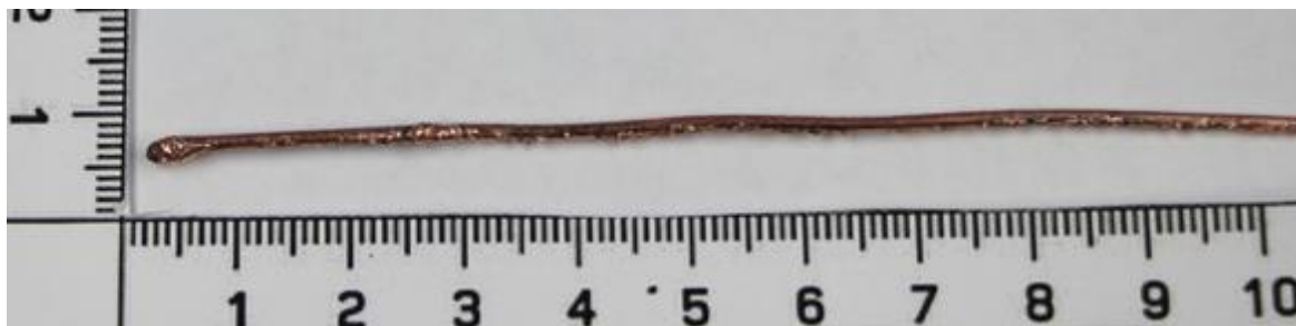
Рис. 1. Повреждения медного проводника в результате теплового действия токов перегрузки (сечение проводника 1,5 мм 2 , кратность перегрузки 3,4)
