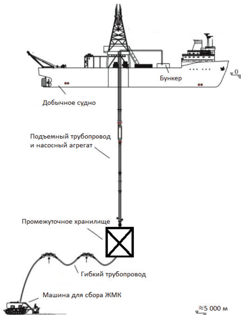
Рис. 1. Комплекс добычи на основе глубоководной машины для сбора ЖМК
