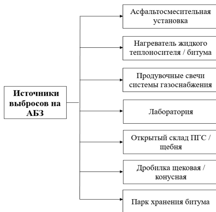
Рис. 2. Основные источники выбросов на асфальтобетонном заводе
