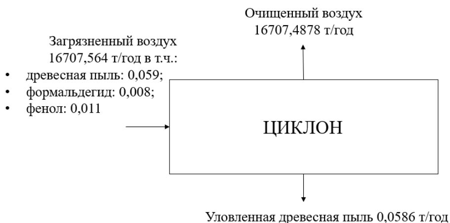
Рис. 2. Блок-схема существующей технологии очистки выбросов от древесной пыли
