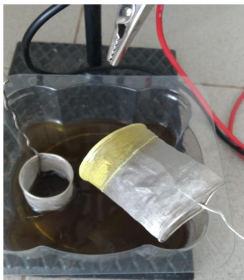
Рис. 2. Электролиз при низких значениях плотности тока. Осаждение серы
