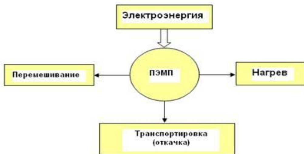
Рис. 1. Схема распределения функций ПЭМП
