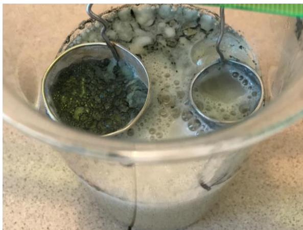
Рис. 1. Электролиз при высоких плотностях тока. Образование полисульфидов
