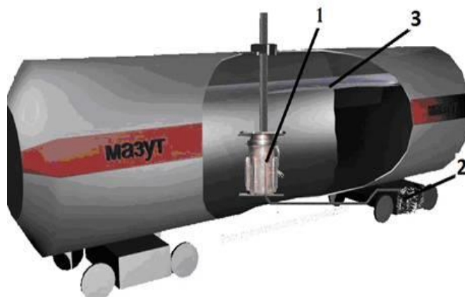
1 – ПЭМП погружного типа; 2 – генератор переменного тока; 3 – транспортируемый материал Рис. 2. Конструктивно-технологическая схема разогрева и слива вязкого материала с помощью ПЭМП
