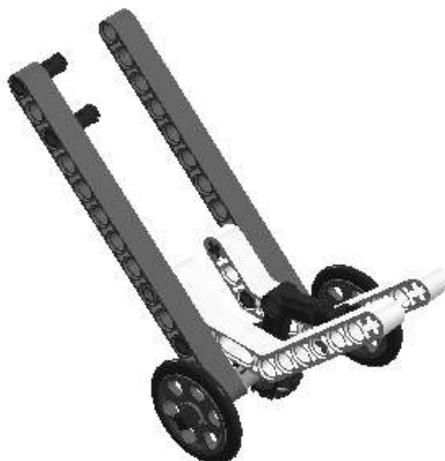
Рис. 1. Модель храпового механизма
