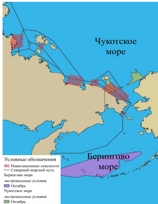
Рис. 5. Зоны брызгового обледенения в Чукотском и Беринговом морях в октябре при экстремальных условиях
