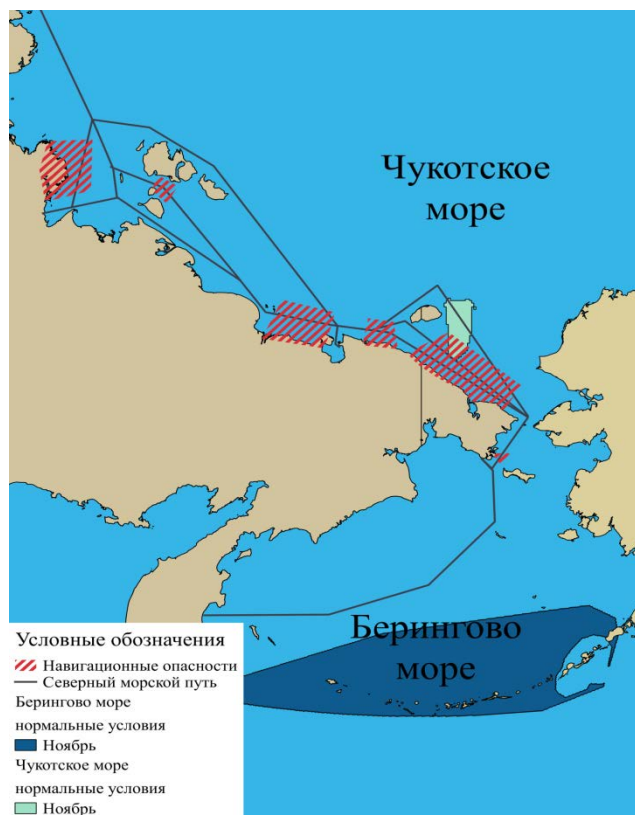
Рис. 6. Зоны брызгового обледенения в Чукотском и Беринговом морях в ноябре при нормальных условиях
