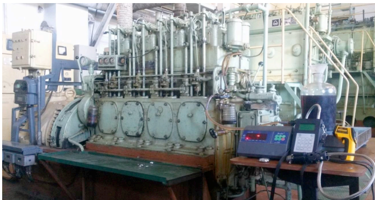
Рис.1. Исследовательская установка для оценки технико-экономических характеристик судового дизеля [4]
