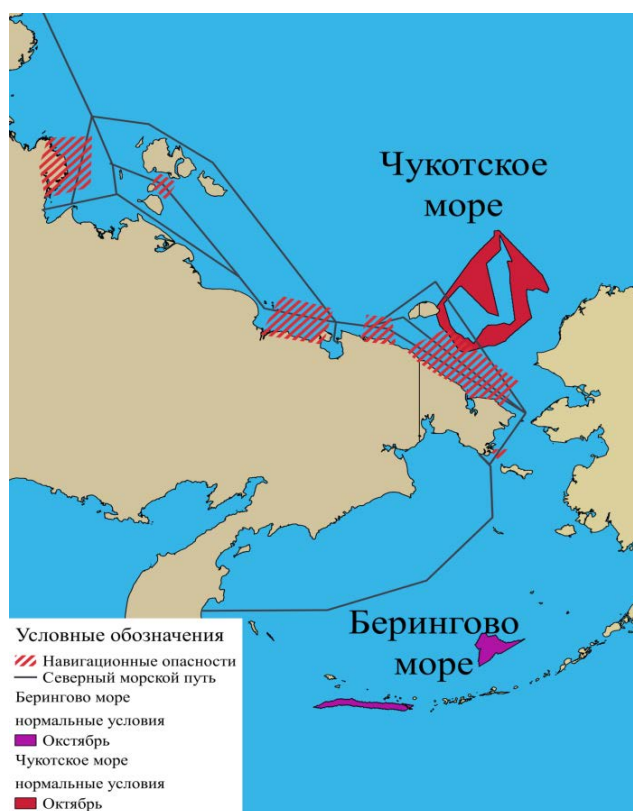
Рис. 4. Зоны брызгового обледенения в Чукотском и Беринговом морях в октябре при нормальных условиях
