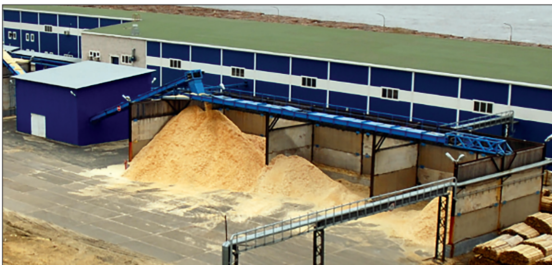
Рис. 1. Открытый щепной бункер на ЗАО «Лесозавод 25» Fig. 1. Open chip bunker at CJSC Lesozavod 25
