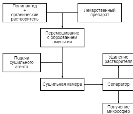
Рисунок 10 – Принципиальная схема метода распылительной сушки [14]
