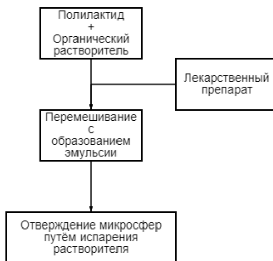
Рисунок 4 – Принципиальная схема метода выпаривания растворителя
