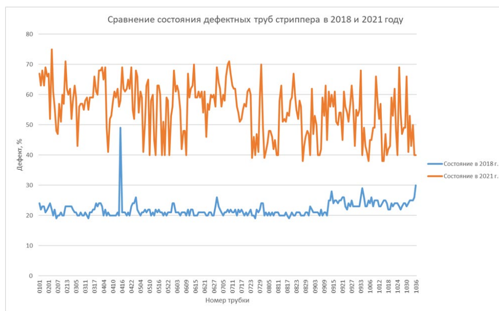
Рисунок 4 – Сравнение состояния дефектных труб стриппера в 2018 и 2021 году
