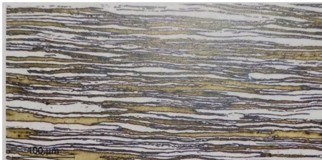
Рисунок 2 – Ферритно-аустенитная микроструктура теплообменных труб
