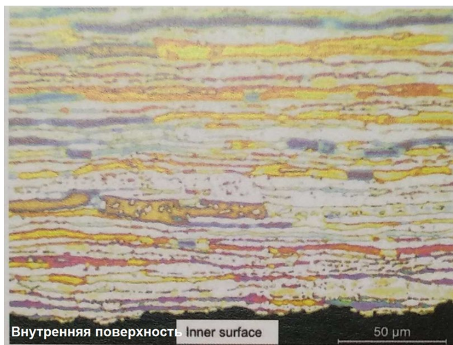
Рисунок 6 – Продольное сечение стенки теплообменной трубы
