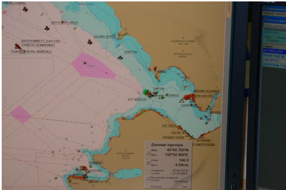
Рисунок Б.3 - Представление информации о наблюдаемых объектах в СУДС «НАВИ-Харбор». Показана навигационная обстановка в районе бухт Врангеля и Козьмина (залив Находка)
