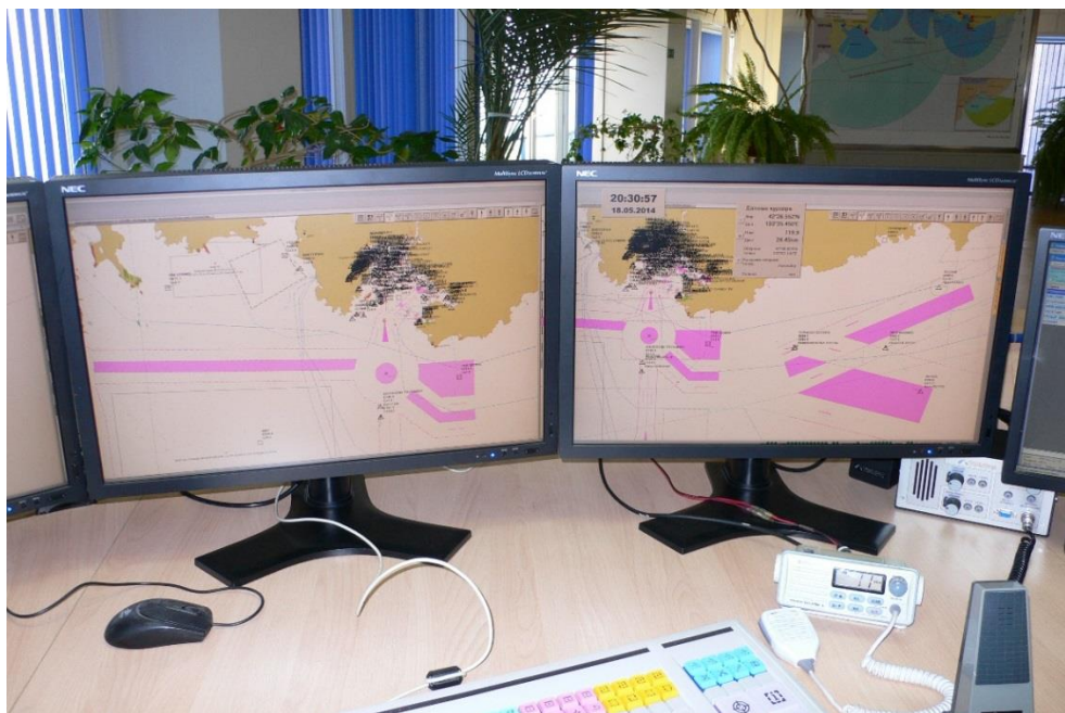
Рисунок Б.2 - Автоматизированное рабочее место оператора СУДС «НАВИ-Харбор» (разработчик – компания «Транзас»). Видна зона ответственности СУДС в заливе Находка
