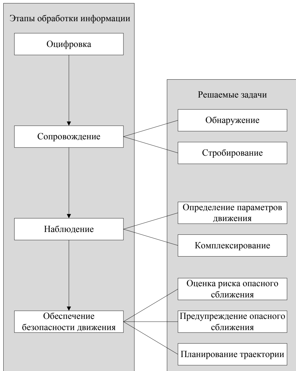
Рисунок 2 - Структура навигационных функций современных СУДС с точки зрения последовательности обработки информации и решаемых задач
