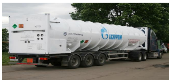
Рис. 6. Крепление знаков опасности на танк-контейнер
