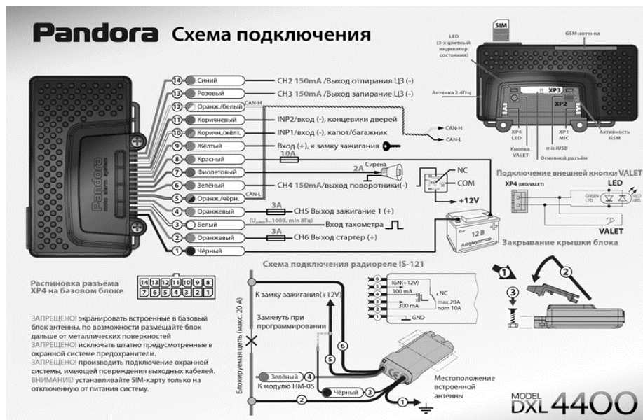
Рис. 1. Схема подключения сигнализации Pandora
