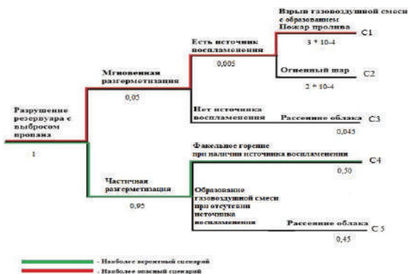
Рисунок 5 – «Дерево событий» возникновения аварий на газофракционирующей установке
