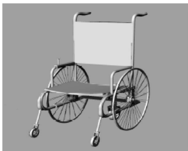
Рис. 2. Ходовая часть транспортного средства с мотор-колесом
