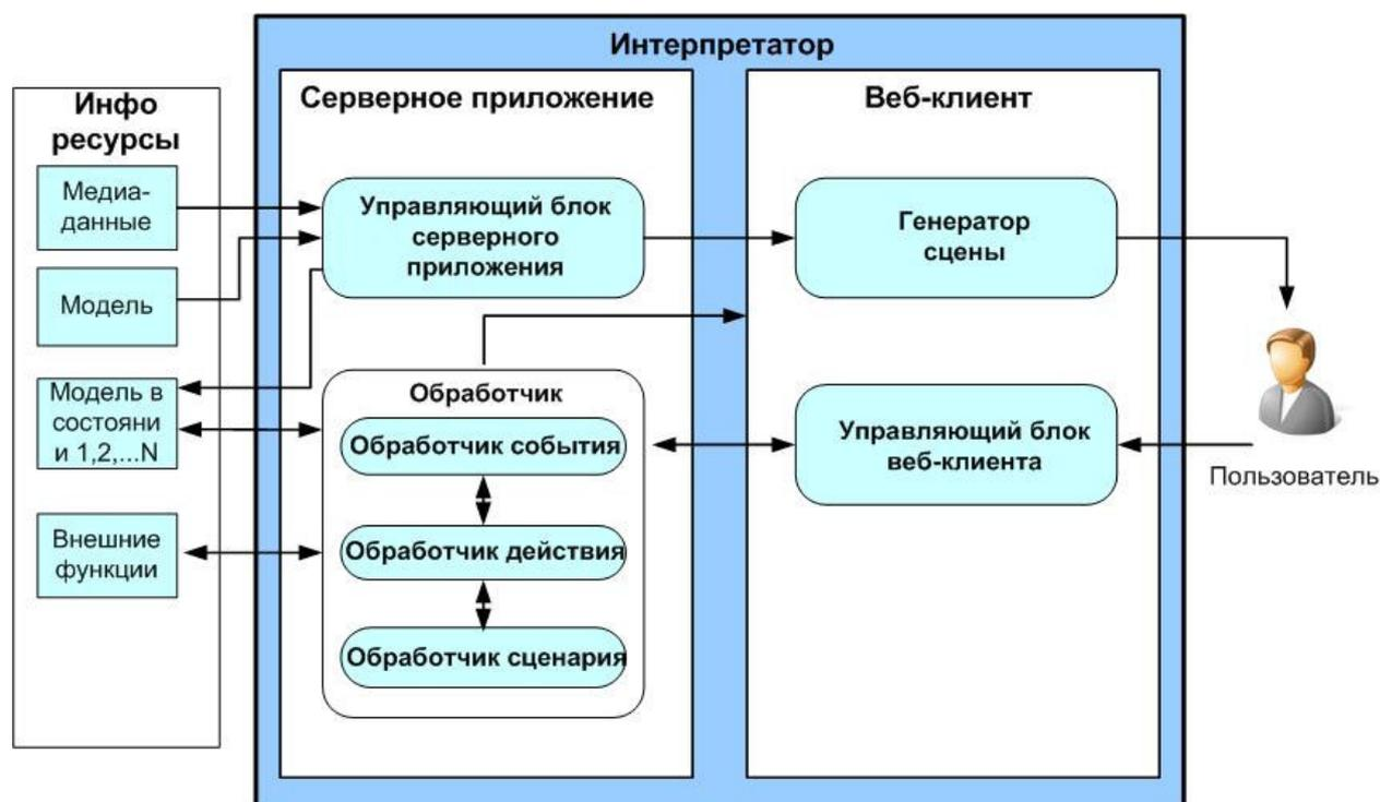
Рис. 3.1.1. Схема интерпретации декларативной модели
