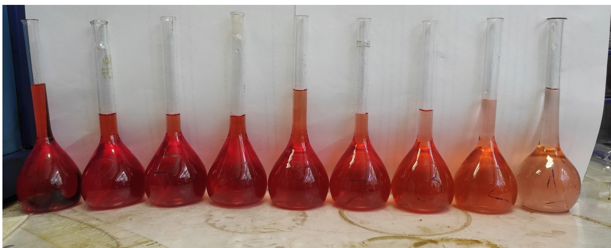
Рис. 2. Растворы конго красного различной концентрации
