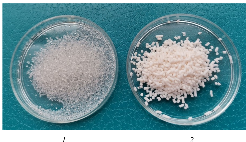
Рис. 2. Внешний вид гранул: 1 — Термоксид 35; 2 — гранулы, сформированные из титаносиликатной пасты и просушенные при температуре 70 °С
