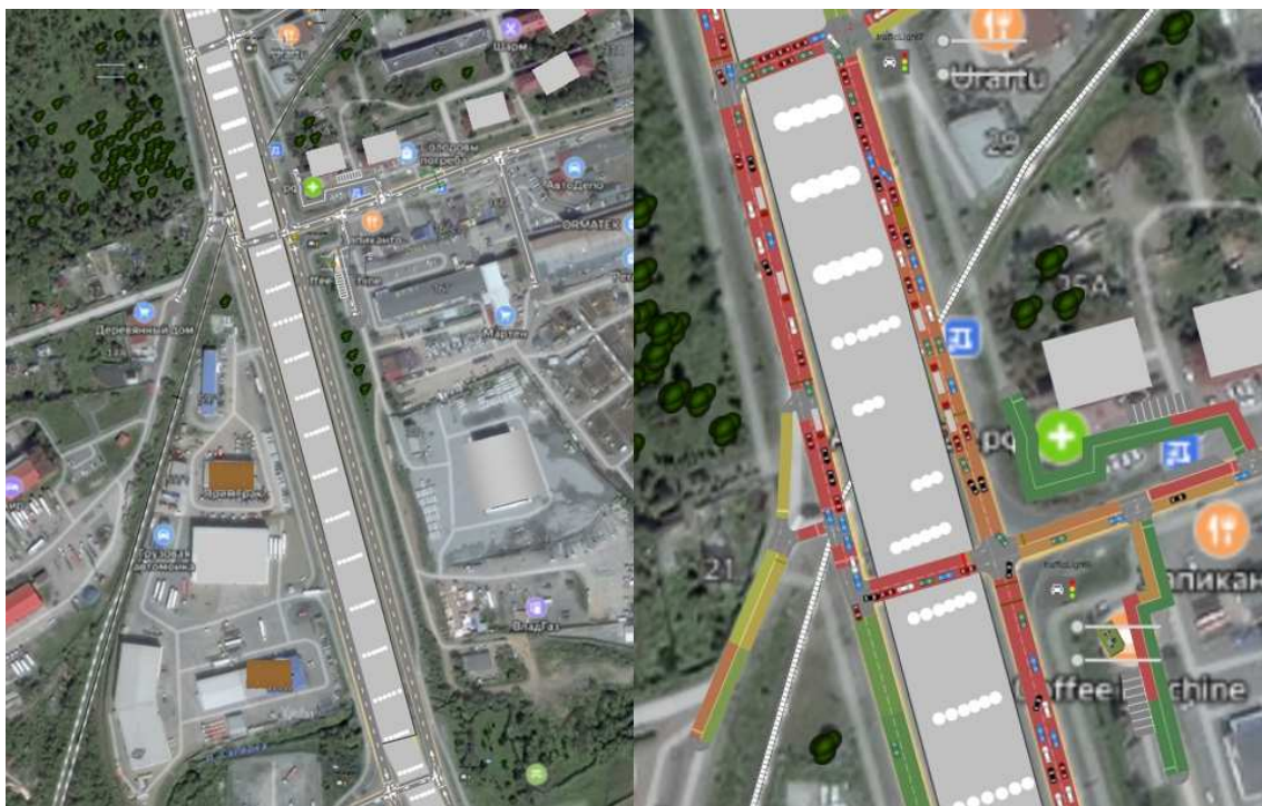
Рис. 3. 2D-визуализация дорожного участка и дорожная ситуация, возникающая во время моделирования на пересечении ул. 1-я Рабочая – ул. Гагарина
