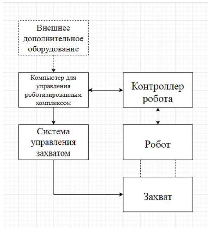
Рис. 1. Структура роботизированного комплекса
