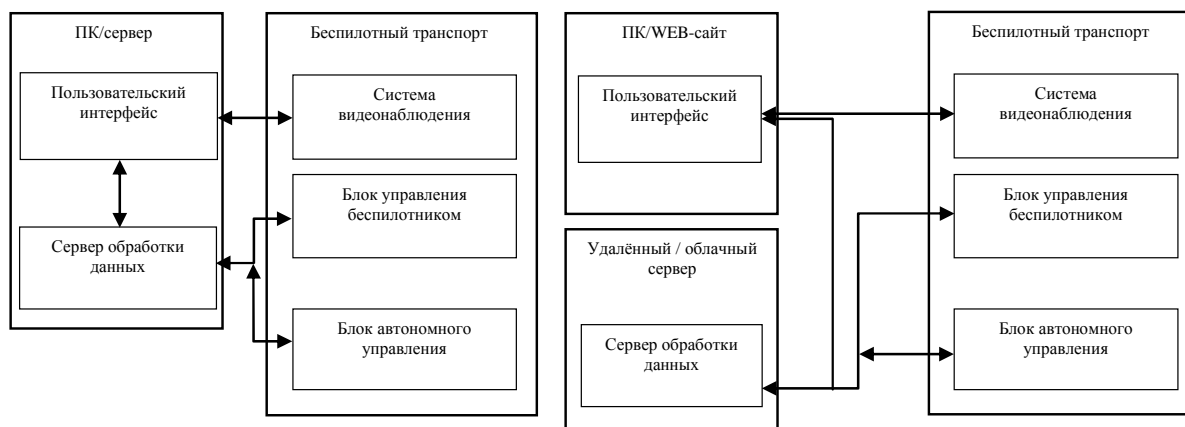
Рис. 3. Способы размещения функциональных блоков
