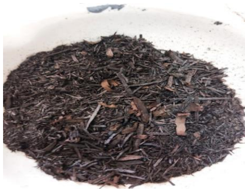
Рис. 4. Карбонизованные опилки после термообработки: T= 300 °C, 20 минут
