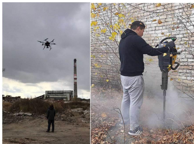
Рис. 4. БПЛА с гамма-спектрометром (слева) и малоглубинное колонковое бурение (справа) на промплощадке ВСЭ
