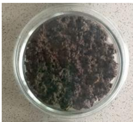
Рис. 1. Субстрат текстильных отходов после стерилизации
