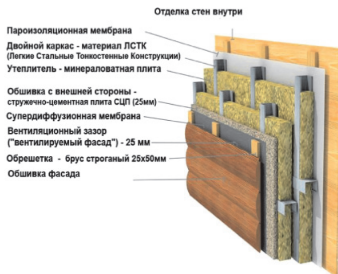
Рис. 1. Узел устройства многослойной стены дома
