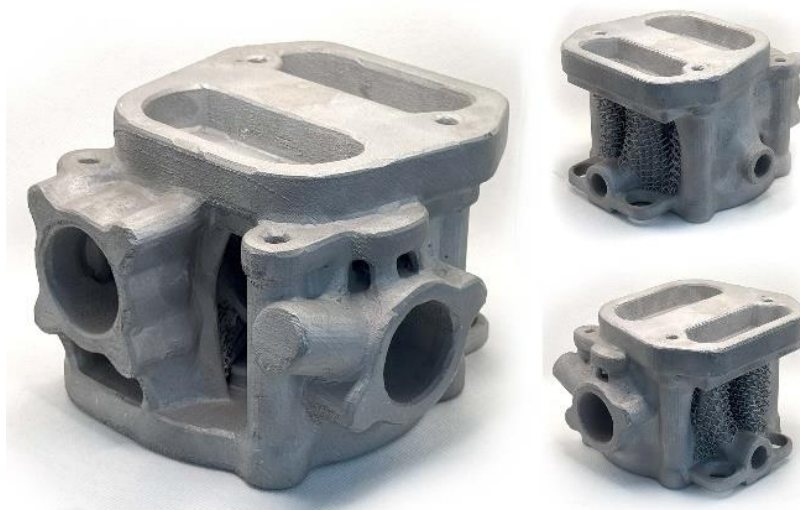
Рис. 6. Результат решения задачи топологической оптимизации детали корпуса электропривода (фото изделия)
