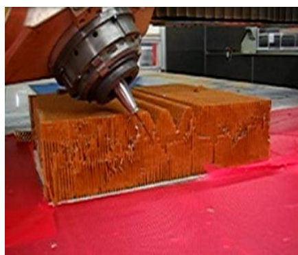
Рис. 11. Предварительная обработка блока ПСП с использованием режущих пластин
