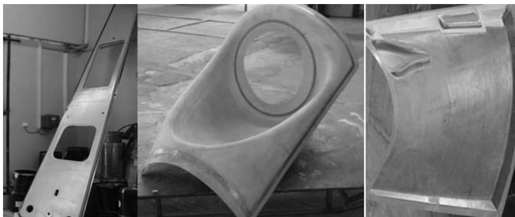
Рис. 6. Панели с различным сочетанием материалов (композитные и армированные, в т.ч. стекловолокном, с углетканью с наклеенной алюминиевой и титановой фольгой, в разном сочетании и разной толщиной)
