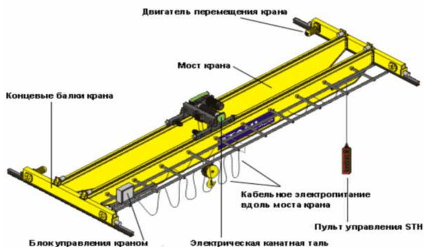
Рис. 2. Устройство мостового крана
