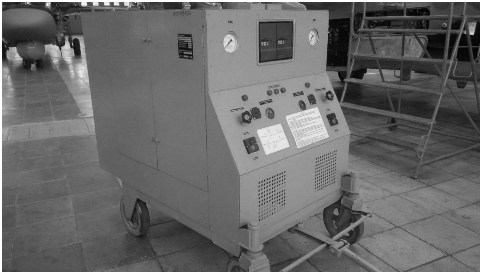
Рис. 4. Стенд обработки и промывки гидросистем вертолета Ка-52 после модернизации
