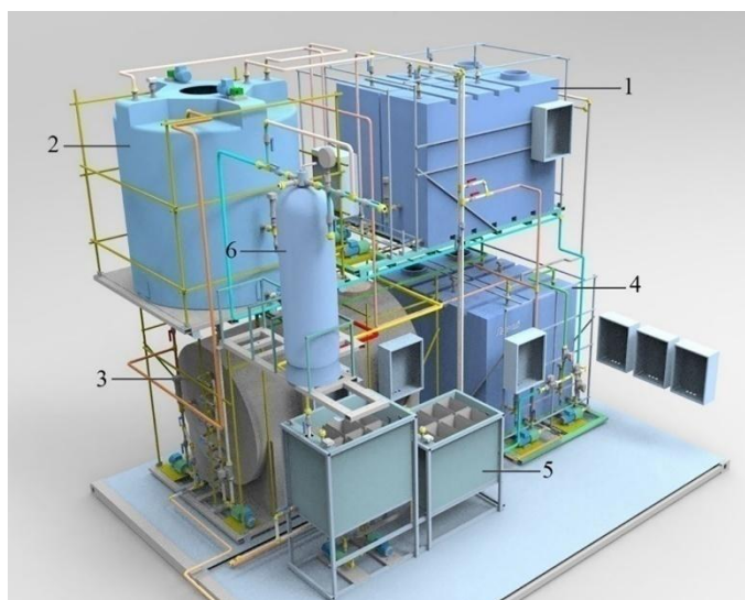
Рис. 1. Опытно-промышленная установка для нейтрализации хромосодержащих отходов гальванического производства
