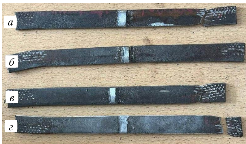
Рис. 1. Образцы после испытания на растяжение: а – образец при температуре +20 °С; б – образец при температуре –28 °С; в – образец при температуре –48 °С; г – образец при температуре –68 °С
