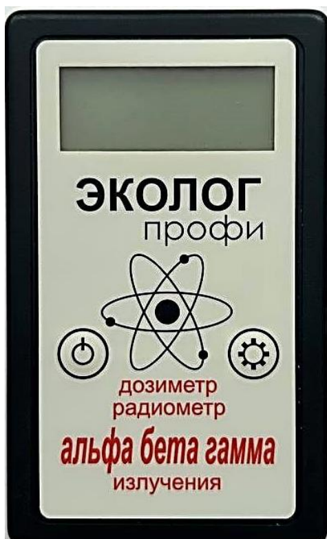
Рис. 1. Прибор для определения мощности амбиентного эквивалента и экспозиционной дозы гамма (рентгеновского) излучения, плотности потока альфа-частиц и бета-частиц с загрязненных поверхностей в помещениях
