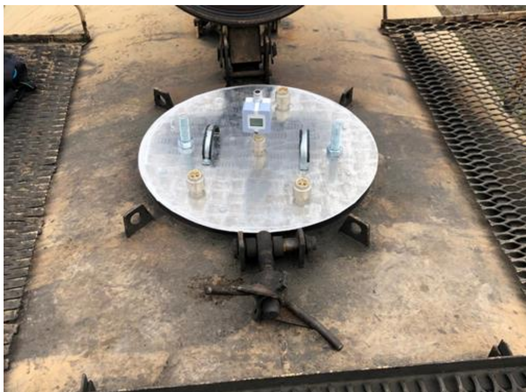
Рис. 1. Устройство измерения объема паровоздушной смеси на горловине цистерны
