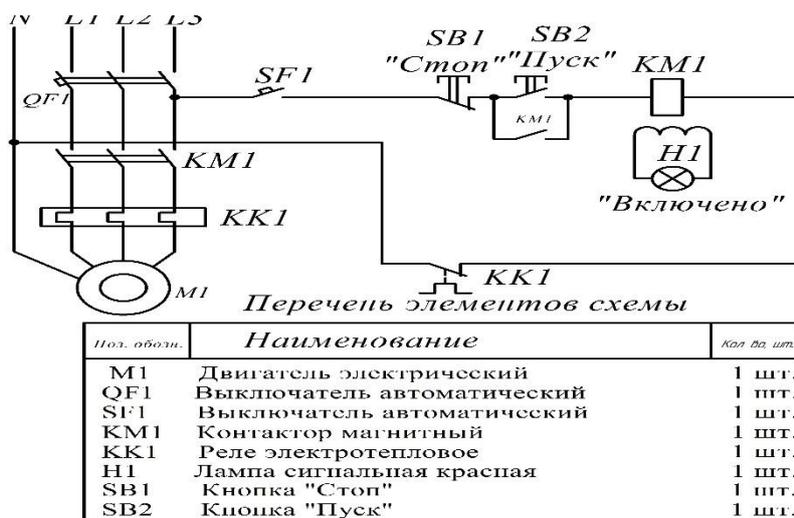
**Рис. 2. Схема принципиальная электрическая управления трехфазным электрическим двигателем без реверса на базе модернизированного магнитного контактора**
