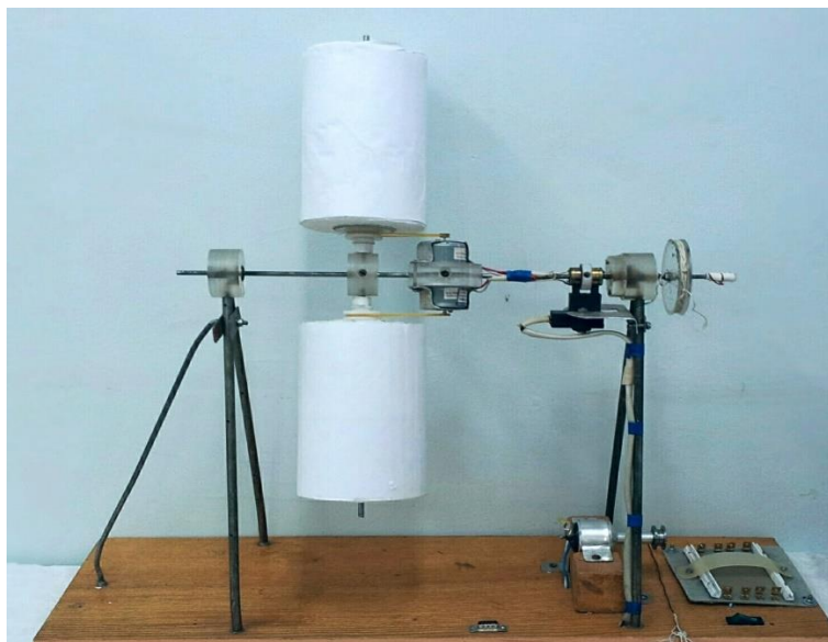
Рис. 1. Экспериментальная установка с двумя гладкими цилиндрами, диаметрами 10 см
