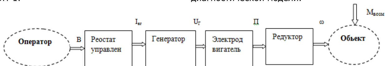
Рисунок 1- Функциональная схема привода при регулировании скорости по схеме генератор-двигатель
