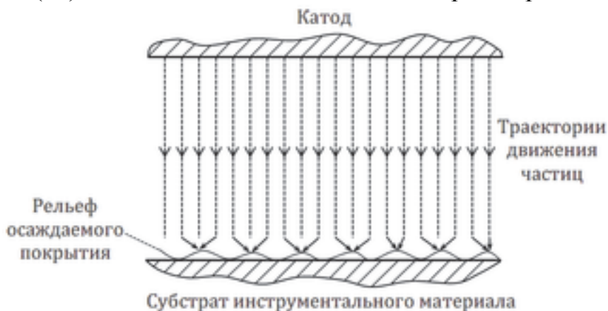
Рис. 6. Схема формирования рельефа осаждаемого покрытия
