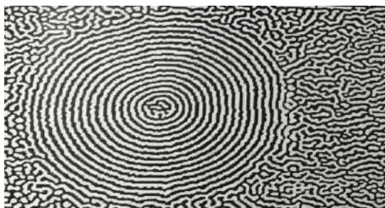
Рис.1 Исходная доменная структура плёнки в размагниченном состоянии (а) и ДДС типа ВЦ в переменном поле.
