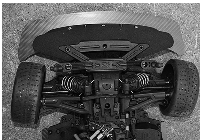
Рис. 4. Шасси из углеродного волокна
