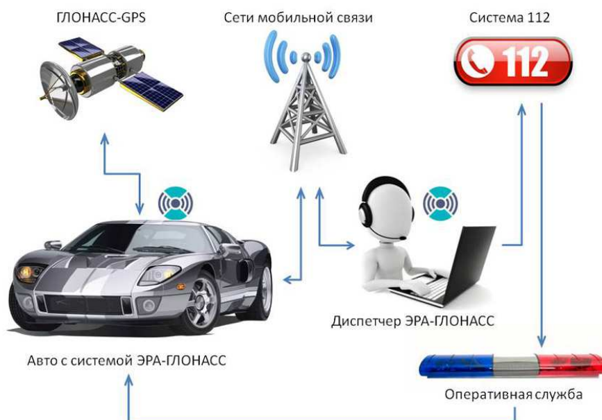
Рис. 1. Алгоритм действий при нажатии кнопки ГЛОНАСС
