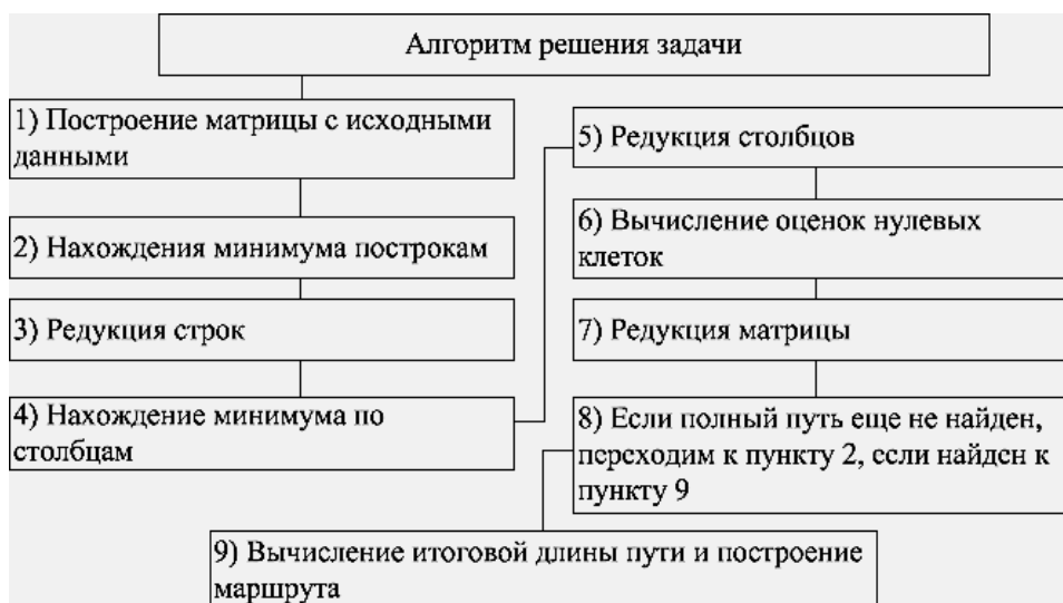
Рис. 1. Алгоритм решения задачи коммивояжера методом ветвей и границ
