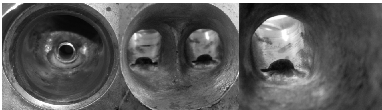
Рис. 5. Фото доработанного выпускного канала ДВС RB20DET
