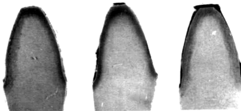
Рис.5. Изменение глубины цементованного слоя зубьев, повторно используемых шестерен
