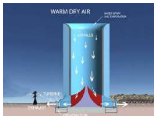
Рис. 2. Схема работы солнечно-ветровой башни [6]
