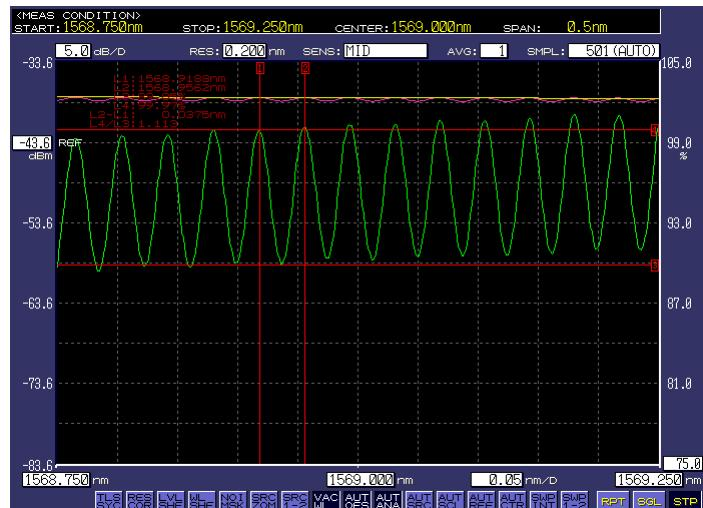
Рис. 5. Измеренный спектр отражения. При диапазоне длины волны 1568.750 nm-1569.250 nm
