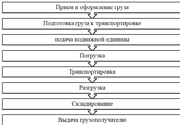
Рис. 2. Технологический процесс организации транспортировки груза
