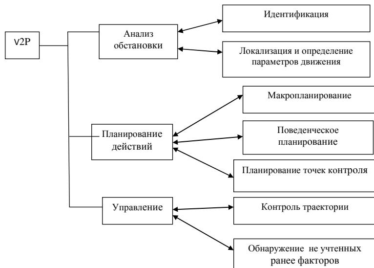
Рис. 1. Принцип действия канала взаимодействия V2P
