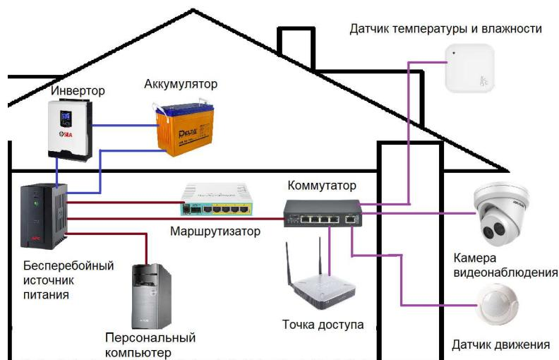
Рис. 3. Схема подключения электропитания
