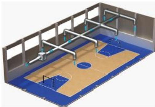
Рис. 1. Система вентиляции в спортивном зале
