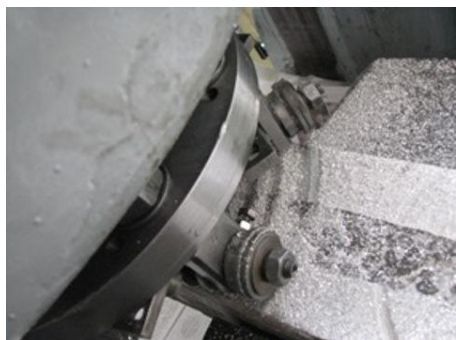
Рис. 1. Фрезерование слитка ротационной фрезой
