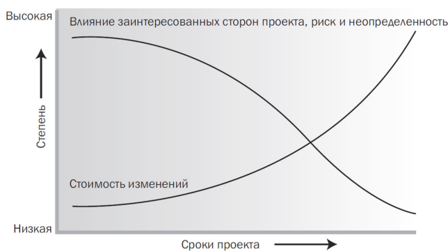
Рис.2. Зависимость влияния управленческих решений на результаты проекта от сроков, на которых они принимаются
